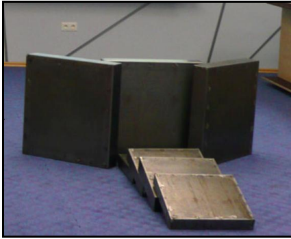
Fig.1 Exemplu de structura fonoabsorbanta realizata
